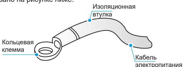
**A** Если нет возможности обжать кольцевые клеммы с изоляцией из-за ограничений на месте, необходимо подсоединить кабели электропитания с одинаковым диаметром жилы к обеим сторонам клеммы электропитания внутреннего блока, как показано на рисунке ниже.
