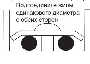
**D** Запрещено зажимать кабели электропитания с жилами одинакового диаметра с одной и той же стороны клеммы, также запрещено использовать два кабеля электропитания с жилами разного диаметра на одной и той же клемме. В противном случае, вероятно ослабление из-за неравномерного обжатия, что приведет к аварийным ситуациям, как показано на рисунке ниже.
