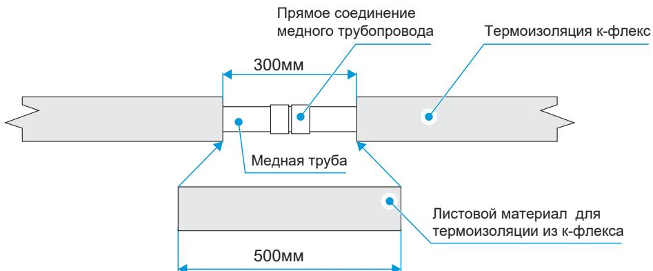
Сначала следует отрезать полосу термоизоляции из к-флекса (полоса должна быть шире зазора), стянуть два конца, смазать kleem и плотно наклеить к-флекс без зазоров.
