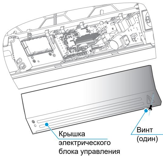
3 Выкрутите винты из электрического блока управления, снимите и отремонтируйте основную плату.
