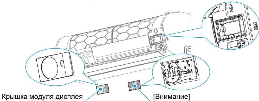
**Снимите один из дефлекторов перемещения жалюзи вверх-вниз, расположенный рядом с отверстиями для винта, открутите винты, затем снимите корпус.**
