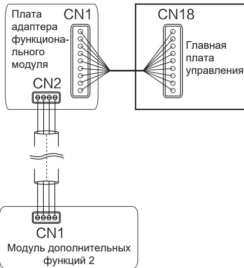
Одновременный выбор плат расширения функций № 1 и № 2
