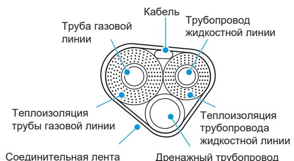
Примечание: если при обматывании дренажный трубопровод будетложен выше трубной обвязки, это может осложнить стекание конденсата и даже привести к току скопившегося конденсата в обратном направлении.
