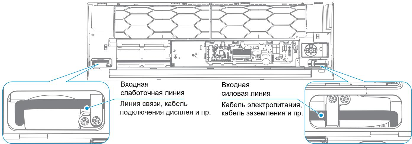
Если из-за большого количества слаботочных кабелей обжимные клеммы не могут зафиксировать их все, нужно двумя саморезами ST3.6\*6.5 закрепить на монтажной пластине зажимы кабеля питания из комплекта дополнительного оборудования и зафиксировать ими кабель слабого тока, который нельзя закрепить на дренажном поддоне.
