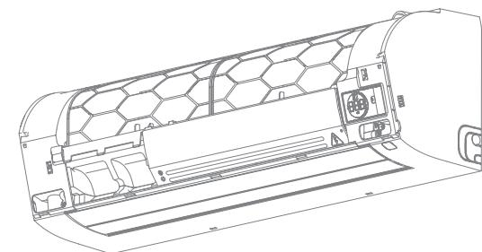
2 Отверните правый винт крышки электрического блока управления и снимите крышку электрического блока управления.
