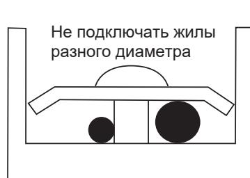
**E** Подсоединенный кабель электропитания нужно зафиксировать обжимной скобой, как показано на рисунке, чтобы кабель не провисал:
