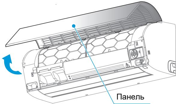
2 Снять сетку фильтра и заменить ее.
