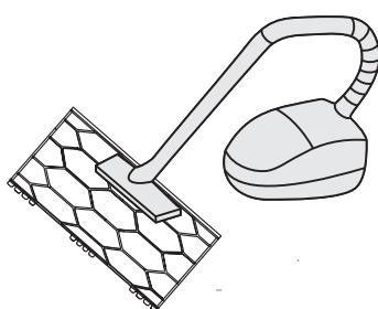
Для очистки можно использовать чистую воду (за исключением модуля с активированным углем), при этом сетка фильтра со стороны забора воздуха должна быть направлена вниз.
